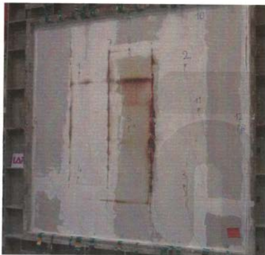
Foto 7: Lato non esposto al termine della prova
