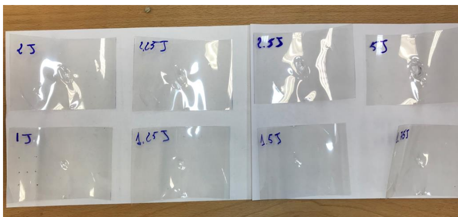
Figura 4: prove d'urto - effetti degli impatti sui provini per energie crescenti (1,00 J, 1,25 J, 1,50 J, 1,75 J, 2,00 J, 2,25 J, 2,50 J, 5,00 J).
