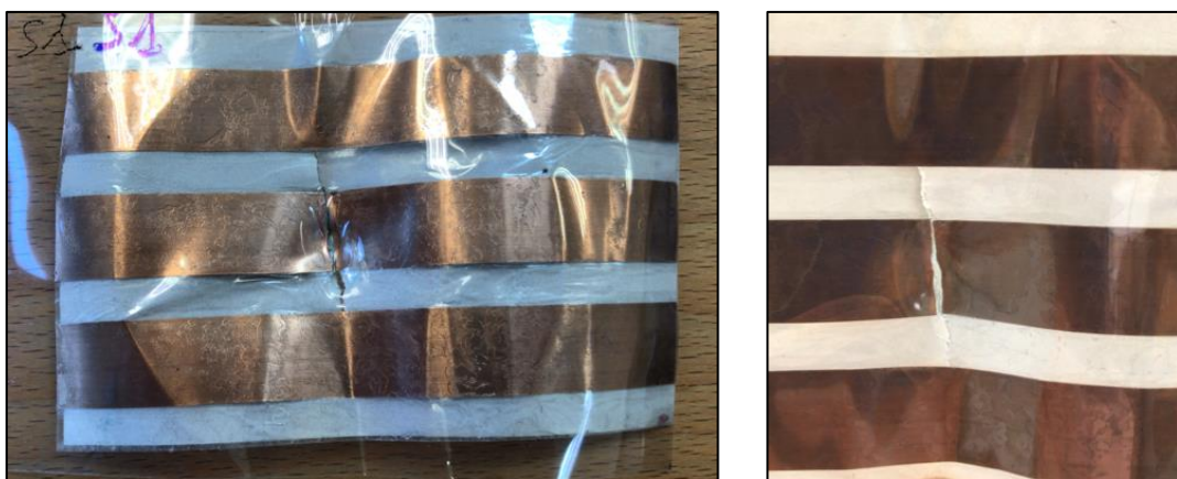
Figura 10: provini di nastro con tre piste conduttrici dopo l'impatto.
