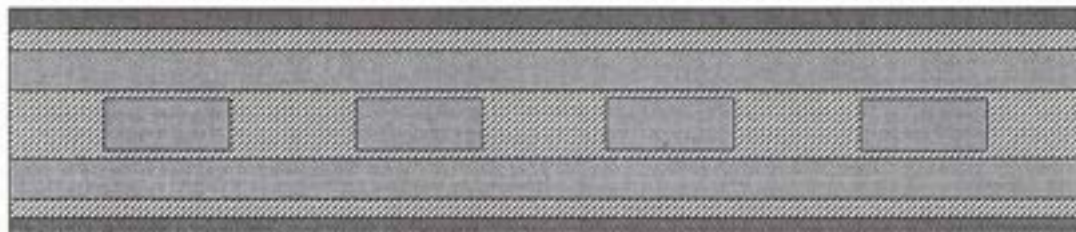
Fig. 02 - Schema esplicativo della versione a 4 conduttori (Sezione trasversale)
