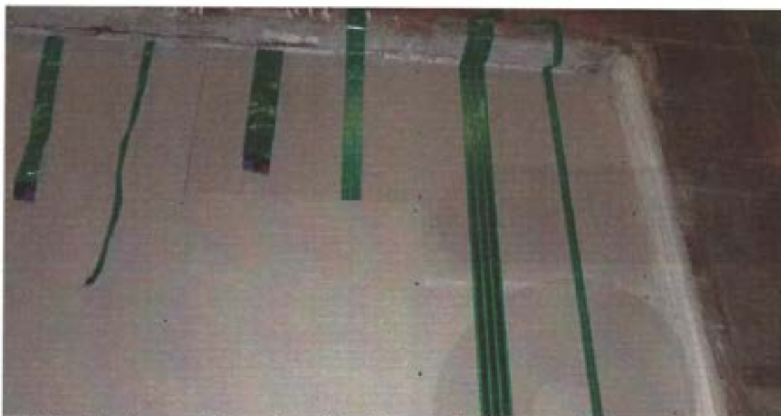
Foto 3: Applicazione nastri conduttori tra i due strati di lastre – lato non esposto al fuoco
