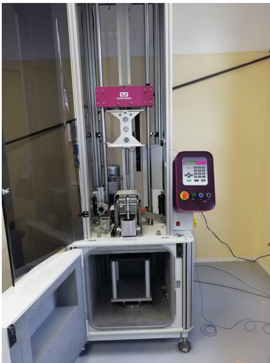
Figura 1: dispositivo per prove d'urto a caduta verticale di grave (Instron CEAST 9350 Drop Tower).
